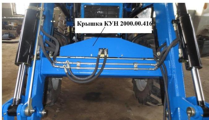
Рис.4 Установка крышки
